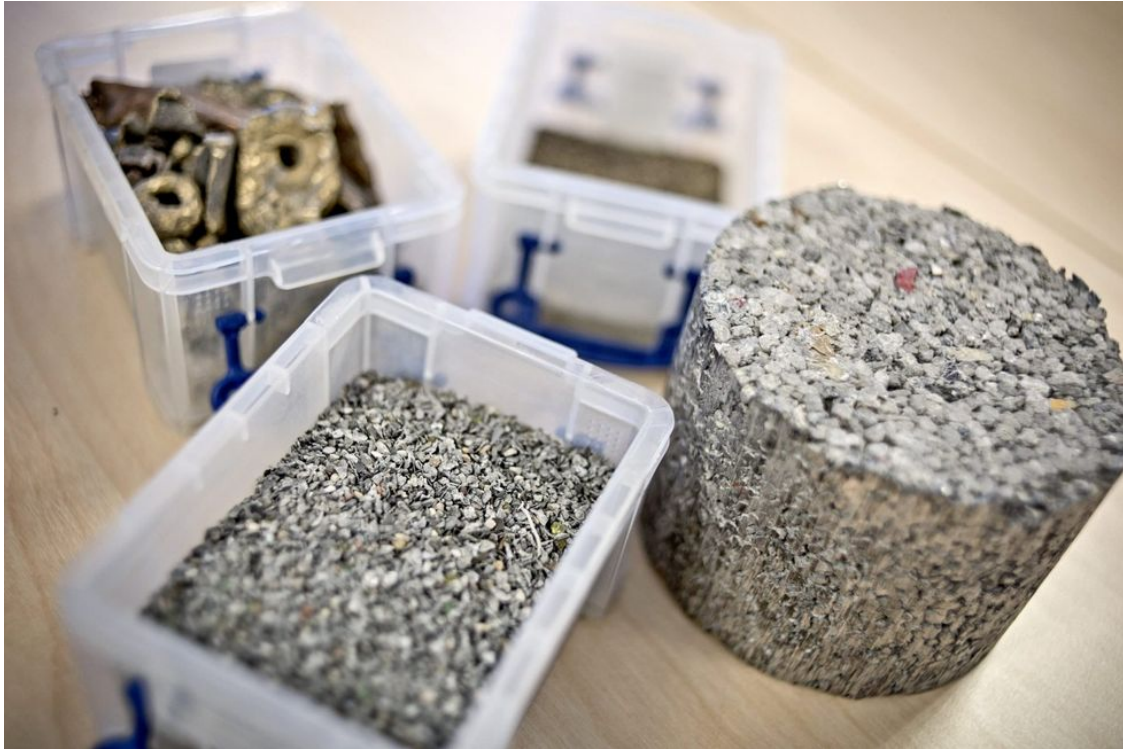
Rent metall: Dette er metall som er tatt ut av avfall fra Bingsa som ble kjørt gjennom et sorteringsanlegg i Nederland som en test. Kubben til høyre er rein aluminium. Foto: Nils Harald Ånstad
